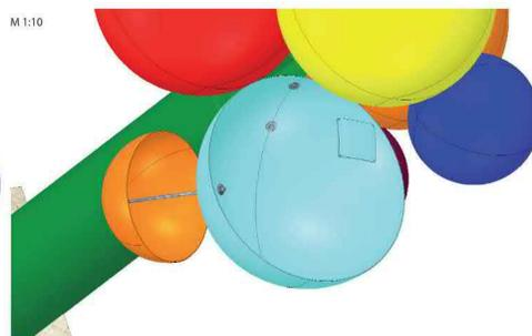
4. Kugeln/Edelstahl: Die Kugeln sind alle auf Maß gefertigt. 4 x 800 mm Außendurchmesser und 4 x 480 mm mit einer Wandstärke von 2 mm. Die vier kleinen Kugeln 480 mm DM werden angeschraubt. Diese besitzen innen (auf die gesamte Länge) eine Gewindestange (Edelstahl) M12. Der Vorteil dessen ist, dass es so zwei Auflagepunkte durch das Verschweißen gibt.
